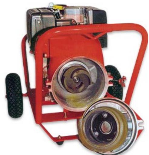
\* Corps de pompe démontable sans outils pour nettoyage turbine
